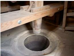
宝丈水車の内部を見せてもらった。搗き臼と先輪の様子がよくわかる。石製の先輪は八多の水車の特徴だろうか。精巧な細工だ。
